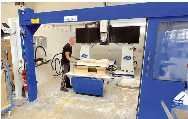
Seit 2020 fräst Swissplast größere Teile auf der 5-Achs-CNC-Portalfräsmaschine P-S-F(25–13).
